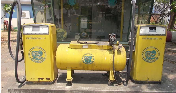
ภาพที่ 3 ปิ๊มจ่ายน้ำมันและถังเก็บน้ำมันสถานีบริการองค์การเชื้อเพลิงสามทหาร
